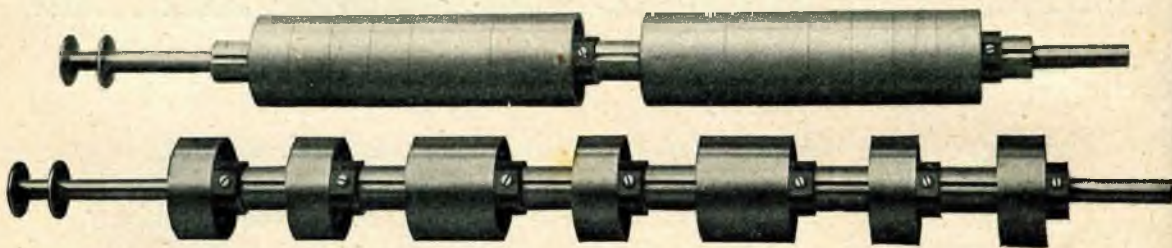
71. ábra. Oldalmozgást is végző változtatható közvetítő acéldörzshenger nagyobb szabású gépekhez.
