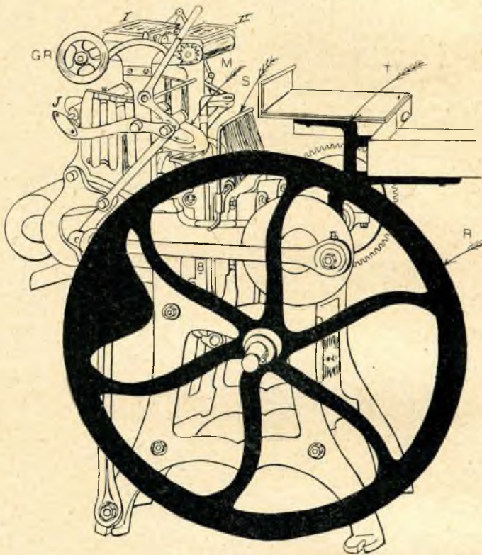
35. ábra. Anger-féle Liberty taposó-gyorsajtó lendítőkerékkel.
