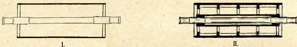
10. ábra. I. régi és II. újabbfajta gyorsajtó nyomóhengere keresztmetszetben.
